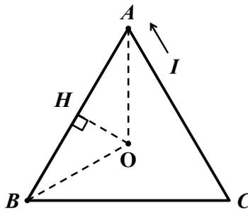
図 3.1 正三角形の電流回路
