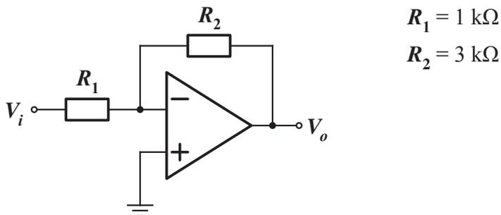
この回路は( (1) )増幅回路である。この回路の動作について考える。非反転入力端子が接地されているので、反転入力端子の電圧は( (2) )となる。これを( (3) )という。今、入力電圧  $V_i = 1 \text{ V}$  とした時、抵抗  $R_1$  と  $R_2$  に流れる電流は( (4) )。その結果、回路の出力電圧  $V_o$  は( (5) )となる。このときオペアンプの出力端子電流は( (6) )。出力端子に何もつないでいない状態で、その電流の大きさは( (7) )である。
