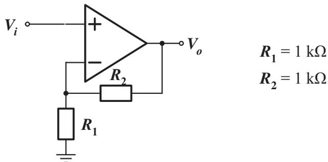
この回路は( (1) )増幅回路である。この回路の動作について考える。今、入力電圧  $V_i = 2 \text{ V}$  とした時、反転入力端子の電圧は( (2) )となる。これを( (3) )という。抵抗  $R_1$  に流れる電流は( (4) )である。反転入力端子のインピーダンスは( (5) )であるため、抵抗  $R_1$  と  $R_2$  に流れる電流は( (6) )。その結果、回路の出力電圧  $V_o$  は( (7) )となる。このとき回路の増幅度は( (8) )である。
