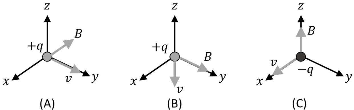
図 2.1 磁界中を移動する荷電粒子が受けるローレンツ力
