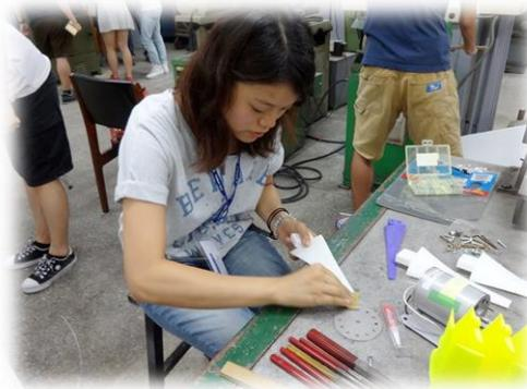
ブレードの手仕上げ研磨
