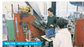
MECHLAB.(メカラボ)の低速翼列風洞装置
