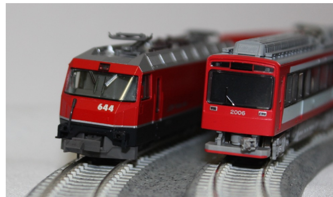
図 2.106 重力と遠心力の合力がレールを押し方向になれば、列車は安定する
