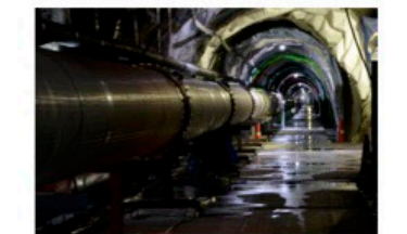
重力波観測装置KAGRA：岐阜県神岡鉱山跡地に作られた一辺3kmのレーザー干渉計で、重力波を捕らえる準備が進められています。
