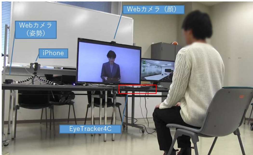
図 32 実験の様子と HW の配置
