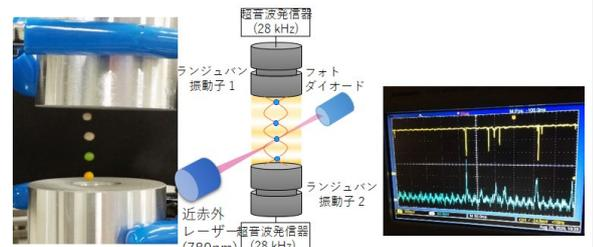
(左)音響場に捕捉された粒子(中)観測装置図の概要(右)粒子が散乱したレーザー光の観測
