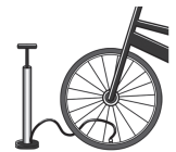
タイヤに空気を入れると空気入れが熱くなる (気体にした仕事=正)
