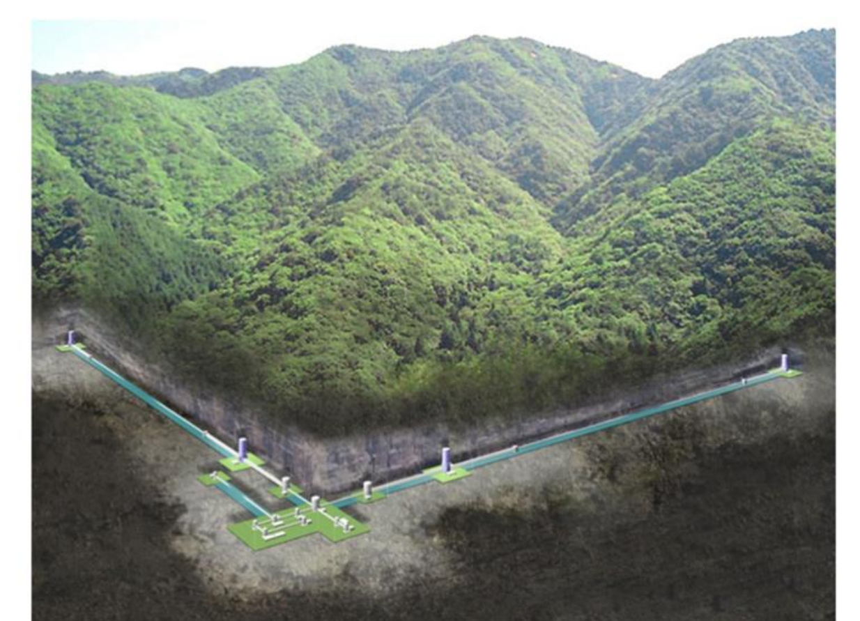
地下に建設された重力波望遠鏡「KAGRA」の俯瞰図。L字型トンネルの1辺は3キロ (東京大学宇宙線研究所提供)
