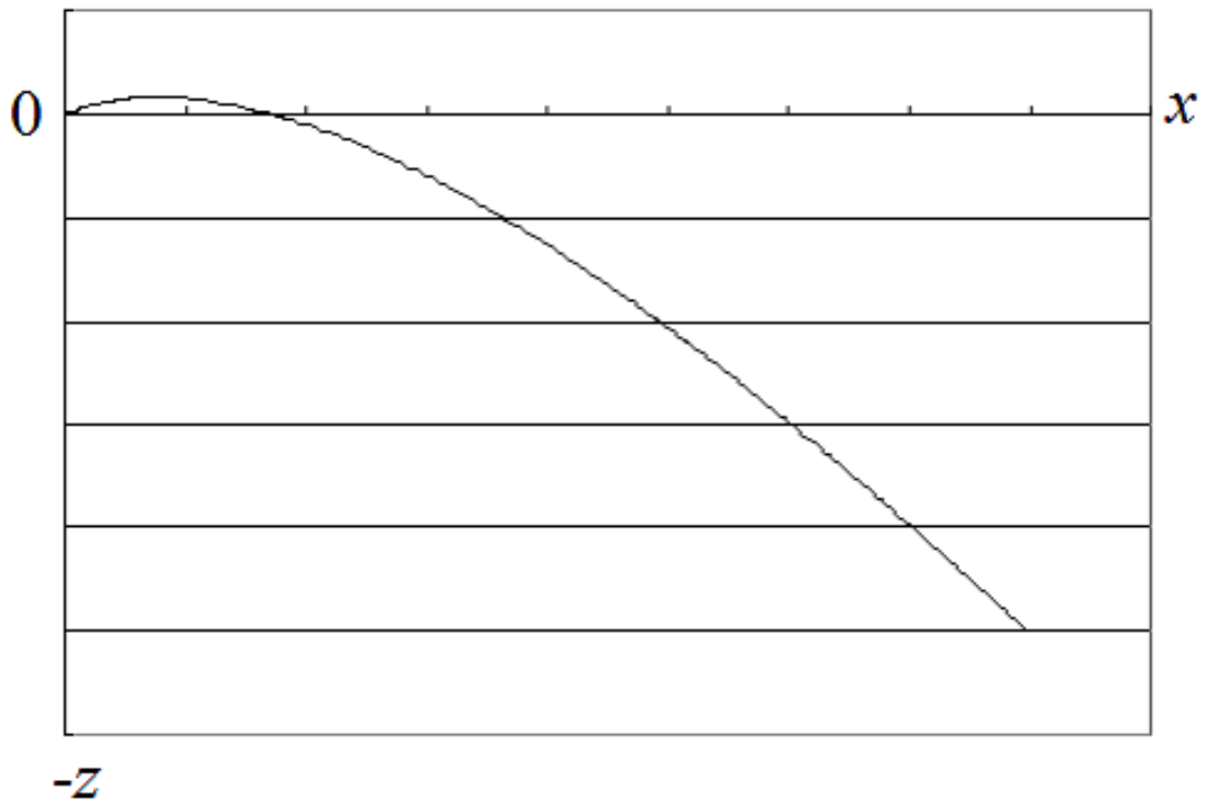
図 17: k = 100 のときの t = 0 周辺を拡大したグラフ。僅かに浮き上がった後に落下し始めていることがわかる。
